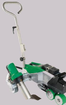
La saldatrice automatica VARIMAT 500 offre sicurezza nella saldatura su tetti piani. L'elevata pressione di contatto, l'innovativo meccanismo di inserimento dell'ugello e l'asse di trasporto variabile garantiscono la qualità della saldatura.
